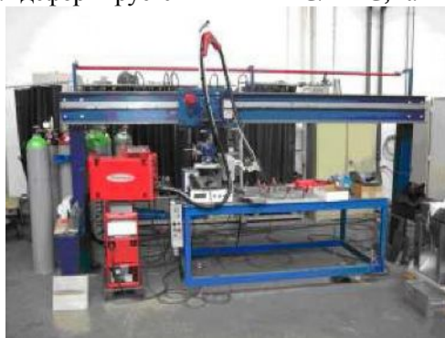
Рис. 2. Сварочная установка ISAF с техникой VR 7000 CMT
