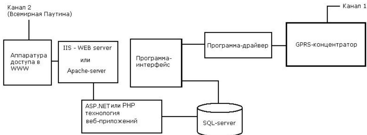
Рис. 5 - Описание центрального диспетчерского пункта-сервера.
