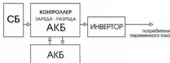
Рис. 3. Принципиальная схема ФЭУ
