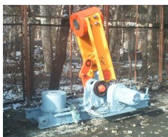
Рис. 1. Механический генератор ударных импульсов высокой мощности ГУИМ-1
