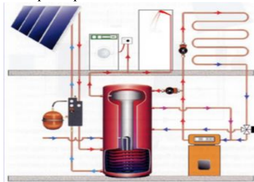
Рис. 2. Тепловая схема активной солнечной системы горячего водоснабжения и отоп-е
