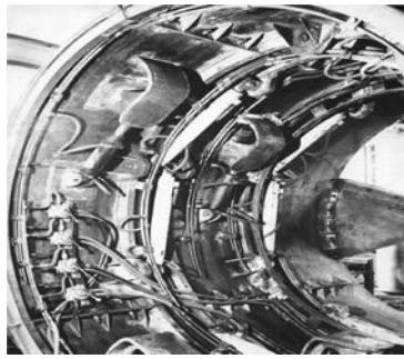
Рис. 1. Расположение гидроцилиндров трансмиссии в геоходе ЭЛАНГ-3
