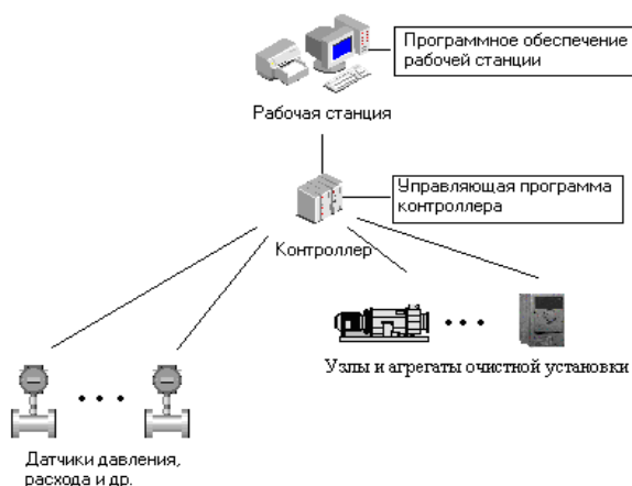
Рис 1 - Структурная схема системы автоматизированного управления распределенной системой
