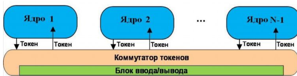
Рис.1 Упрощенная структура параллельной потоковой вычислительной системы (ППВС).
