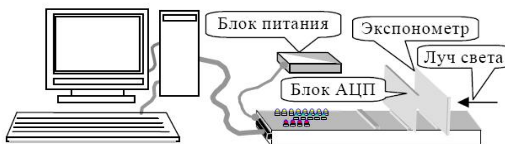
Рис. 4. Условная схема установки цифрового экспонометра.
