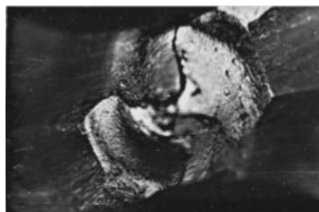
Рис.2. Вид износа поперечной кромки h_{\Pi}
