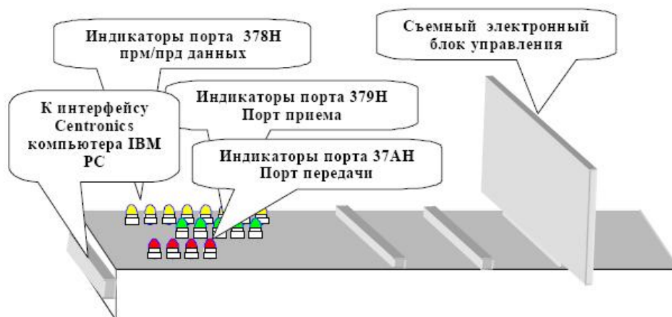
Рис. 1. Структура блока сопряжения электронных плат с компьютером IBM PC.
