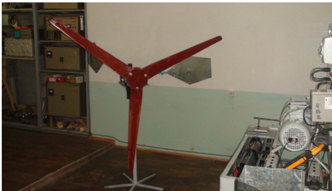
Рис.3. Экспериментальная ветровая установка с мощностью 0,4 кВт.
