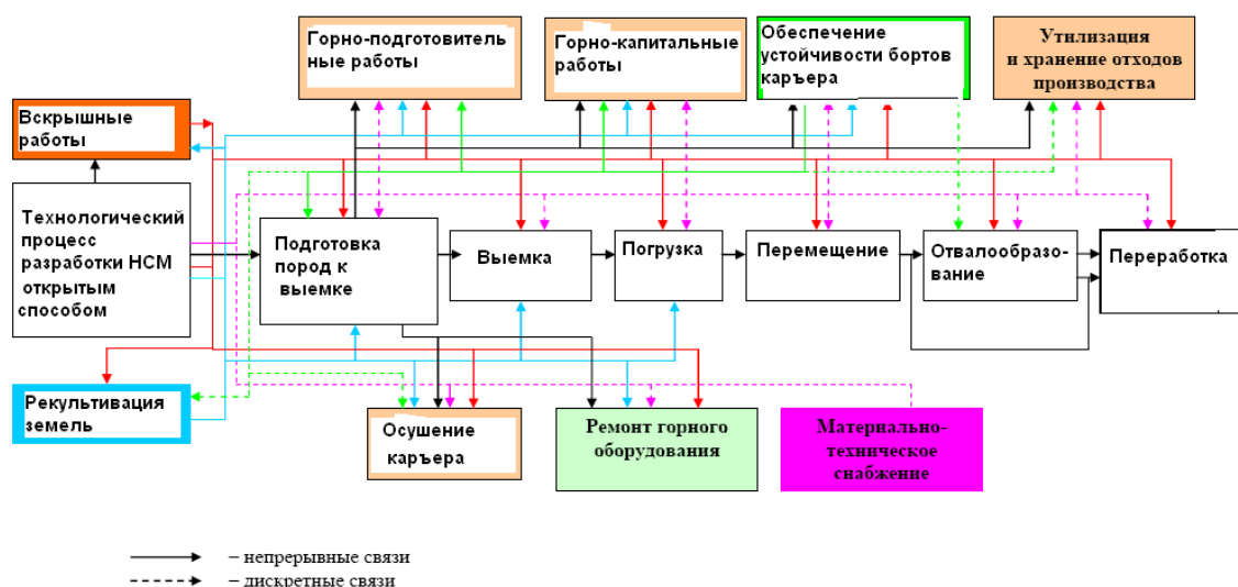
Рис.1. Технологическая схема функционирования карьера
