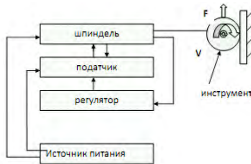
Рис.1. Структурная схема адаптивного устройства регулирования режимами обработки детали на станке.
