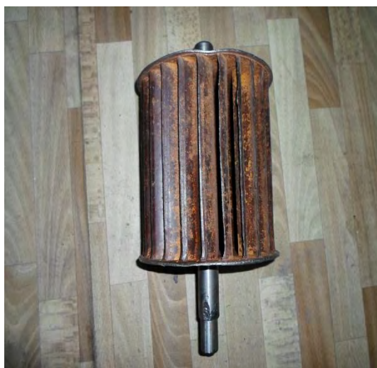
Рис. 3. Гидротурбина с однорядными лопастями
