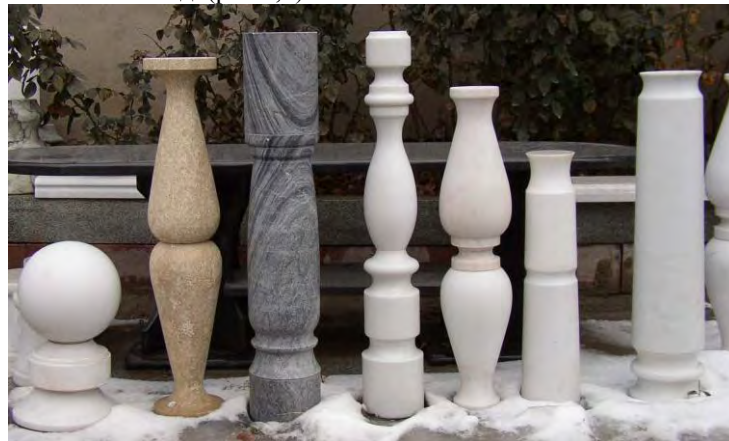
Рис. 3. Разновидности архитектурно-декоративных изделий из природного камня, изготавливаемых на токарном камнеобрабатывающем станке.
