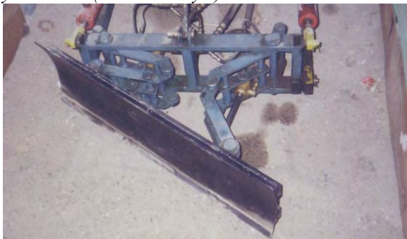
Рис.3. Установка отвала под углом в плане
