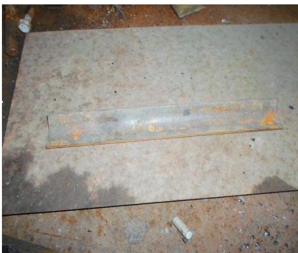
Рис. 2. Полусферическая лопасть турбины
