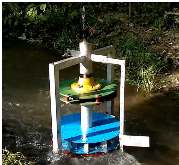
Рис.8. Фото действующего образца бироторной микроГЭС
