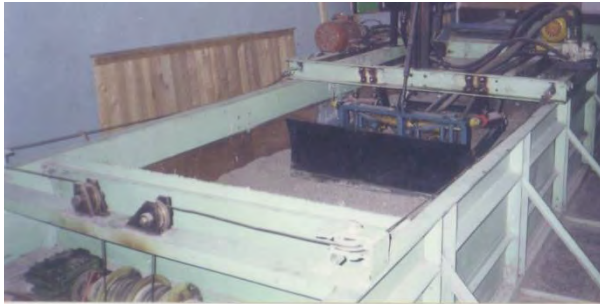
Рис.1. Стенд – экспериментальная моделирующая установка (отвал втянут)
