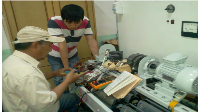
Рис. 5. Испытательный стенд для предварительного определения нужной мощности и частоты вращения на валу асинхронного двигателя, используемый в качестве генератора для работы МикроГЭС
