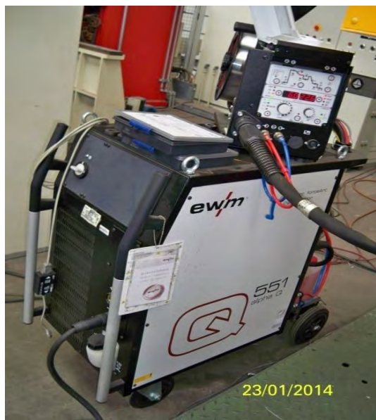
Рис.1. Сварочная установка ISAFc техникой EWM
