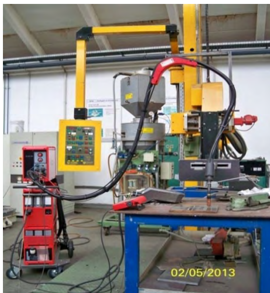
Рис.1. Сварочная установка ISAFc техникой EWM
