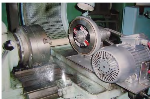
Рис.2. Общий вид технологического модуля с дисковым алмазным инструментом.
