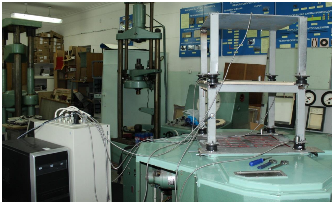
Рис. 6. Подключение STD 2060 к датчикам и крепление датчиков на макет здания.
