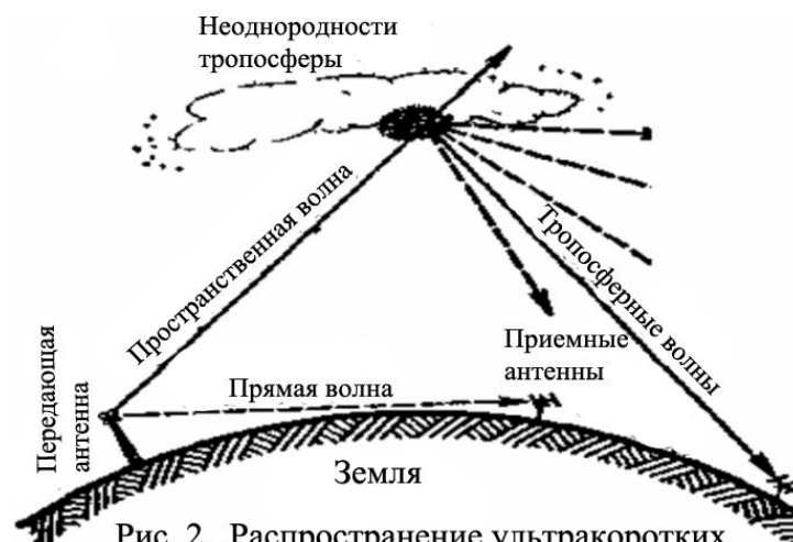
Рис. 2. Распространение ультракоротких волн за счет рассеяния в тропосфере.
