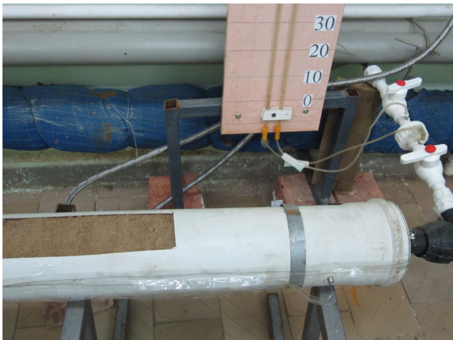
Рисунок 3 – Лабораторная установка для более качественной оценки эффекта теплоотдачи грунта.
