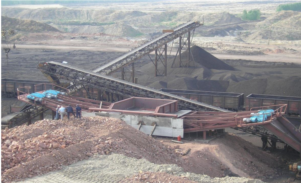
Рис. 1. Конструкция комплекса ДСКА производительностью 1500 т/час в варианте поставки ОАО “Переяславский разрез” (г. Красноярск)
