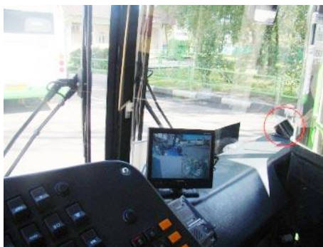
Рис. 6 Жидкокристаллический монитор, установленный в кабине водителя
