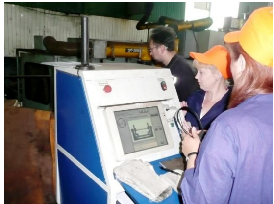
Рис.5. Практические занятия на позиции выходного контроля колесных пар
