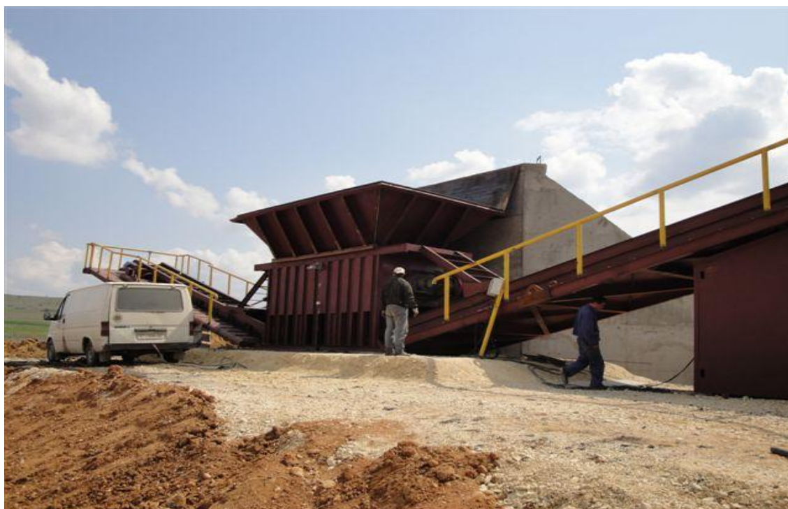
Рис. 4. Конструкция комплекса ДСКА производительностью 600 т/час для одностадийного дробления (до фракции 0-25 мм) и сортировки лигнита в варианте поставки компании “Bitola” (Республика Македония)
