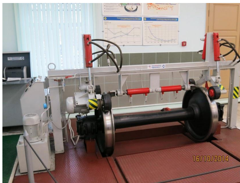
Рис.11. Стенд входного и выходного контроля буксовых узлов колесных пар «Прогноз-1»
