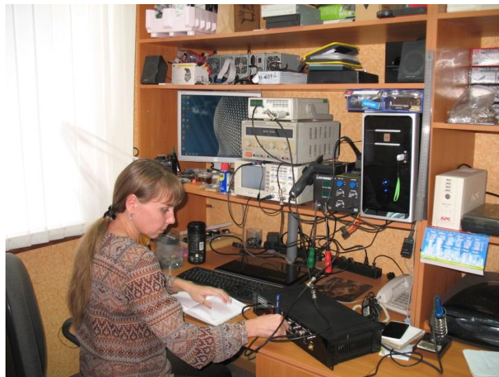
Рис.7. Калибровка ВДО в цеховых условиях
