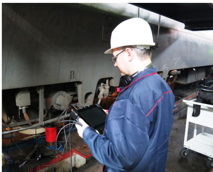
Рис.14. Диагностирование КМБ локомотива системой «Эксперт М»
