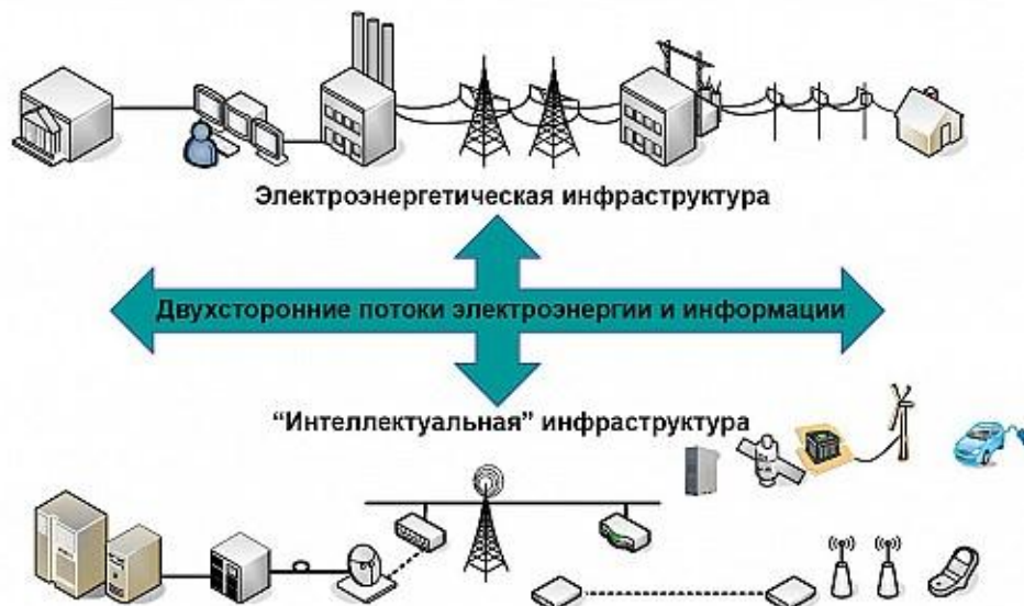
Рис. 1. взаимодействие элементов традиционной энергосистемы с одной стороны, и системы управления, систем телекоммуникаций, «умных» приборов учета, ветрогенераторов, солнечных панелей и т.п. («интеллектуальная» инфраструктура) – с другой стороны.
