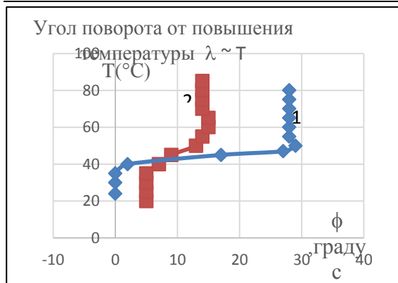
Рис.8. Угол поворота от повышения температуры. Выносы: Кривая 1- предварительно деформированный образец. Кривая 2- недеформированная.
