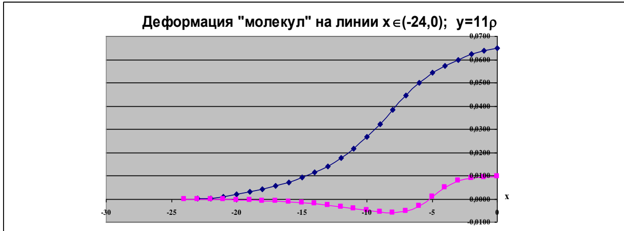
Рис. 12. Диаграмма распределения деформаций \epsilon_x \epsilon_y вдоль горизонтальной оси симметрии балки
