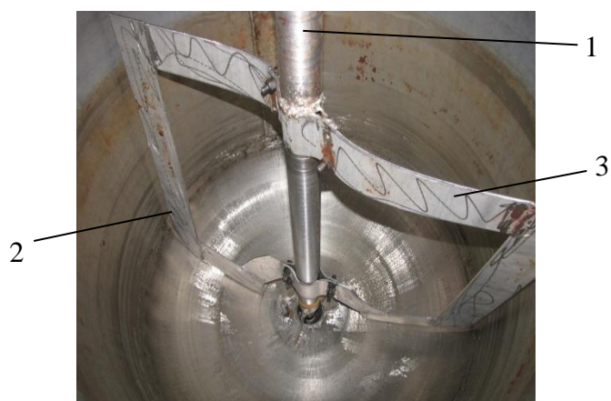
Рис. 2. Мешалка с лопастью: 1-вал мешалки; 2- боковые вертикальные лопасти; 3- верхняя горизонтальная лопасть.
