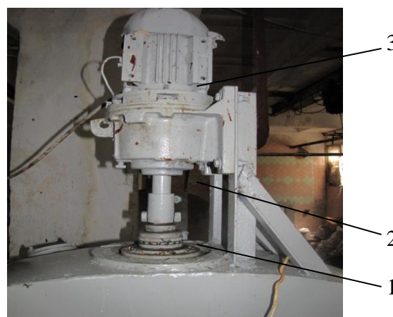
Рис. 3. Крепление мешалки в верхней части аппарата: 1-подшипник; 2-вал мешалки; 3-электродвигатель.
