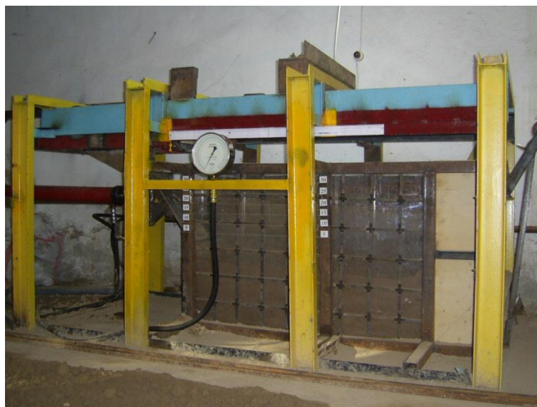
Рис. 2. Стенд для исследования процесса сдвига снега конструкции КГТУ и ТГУ – вид общий
