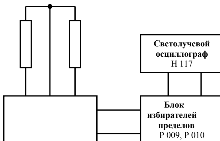
Рис. 3.Схема тензометрирования усилия резания снега
