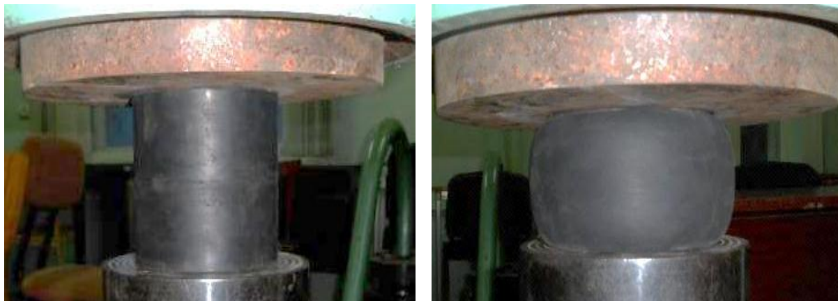
Рис. 1. Образец до испытания. Сжатие резинометаллического образца.
