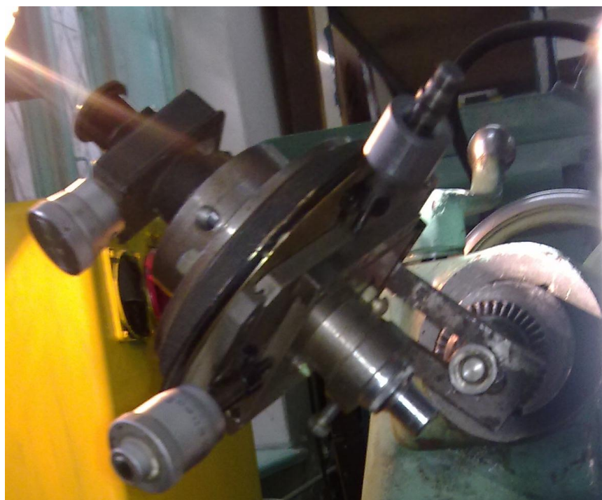
Рис. 2. Оптическое приспособление для измерения высоты нароста
