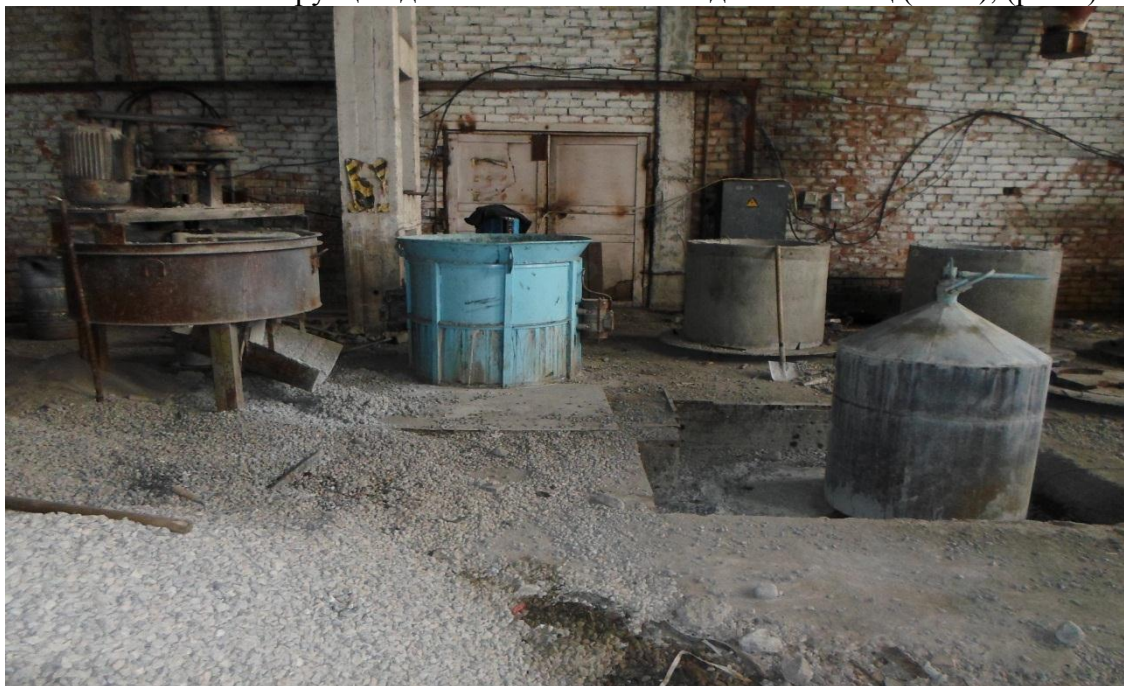
Рис.2. Усовершенствованная конструкция для изготовления колодезных колец (УКК)
