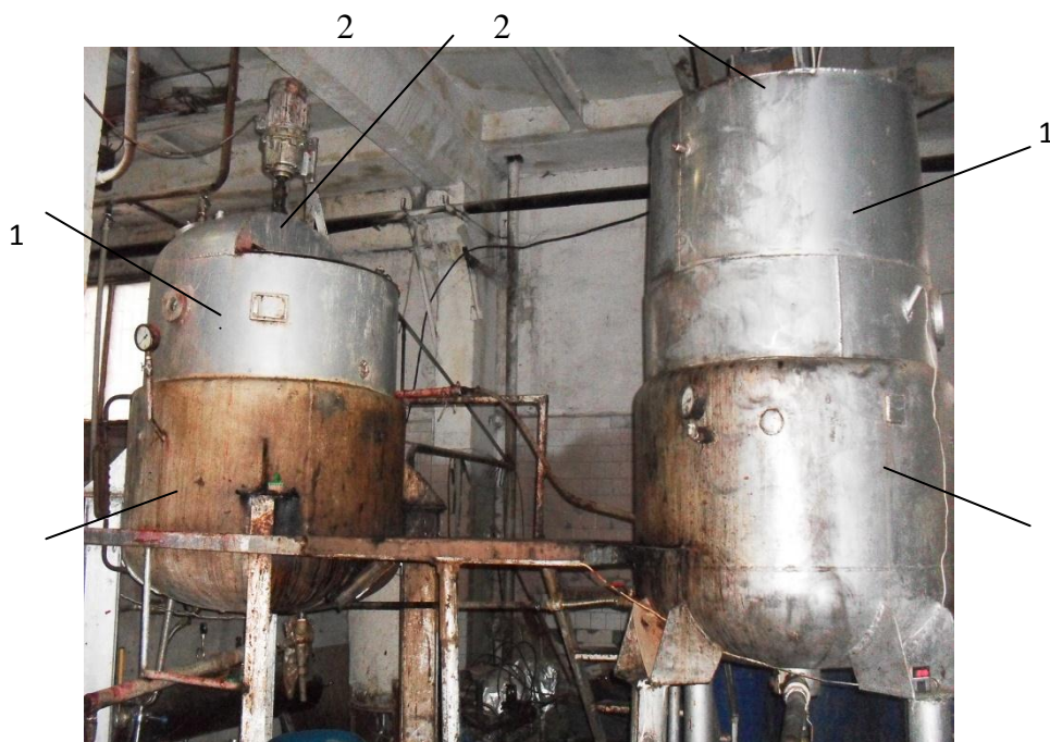
Рис. 1. Комбинированный бродильный аппарат: 1-цилиндрическая часть корпуса; 2- лопастная мешалка; 3-греющая рубашка.
