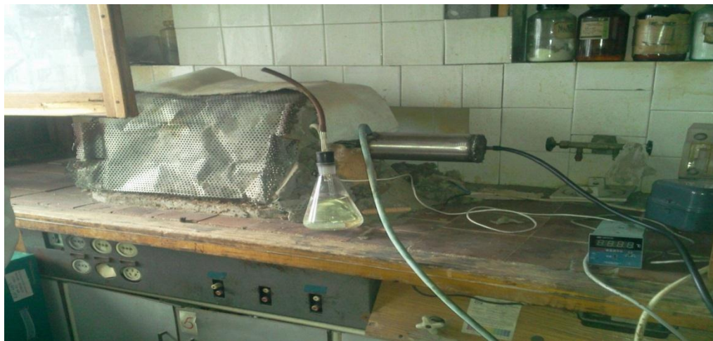
Рис.1. Лабораторная установка для проведения пиролизной обработки
