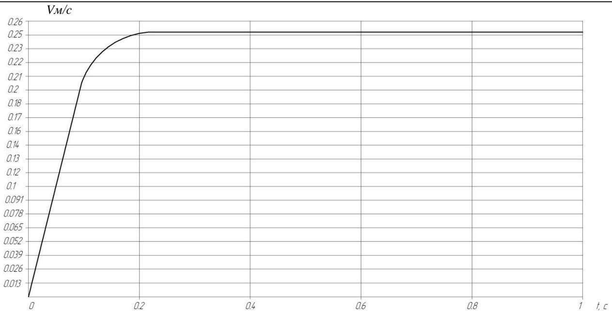
Рис. 3 График разгона силового гидроцилиндра при резкой, мгновенной подаче расхода в силовой цилиндр, при массе движущихся частей более 100 кг.
