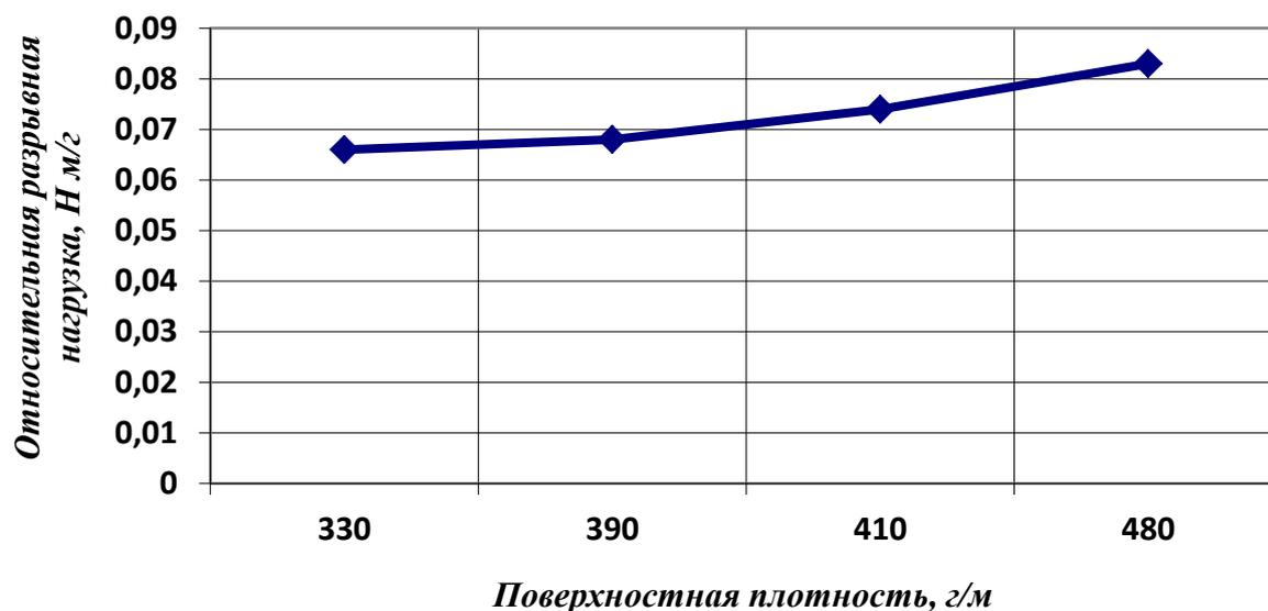
Рис. 4. Влияние поверхностной плотности, г/м<sup>2</sup> на относительную разрывную нагрузку Н м/г.
