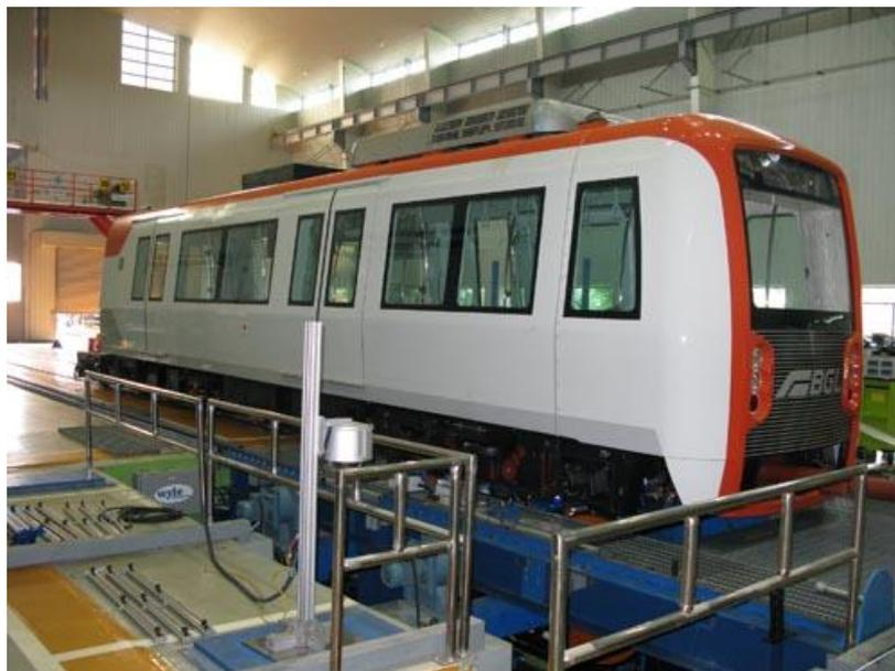
Рис. 5. Динамические испытания модели кузова
