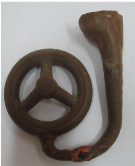
*Рис.10. Парафин-стеариновая выплавляемая модель.*
