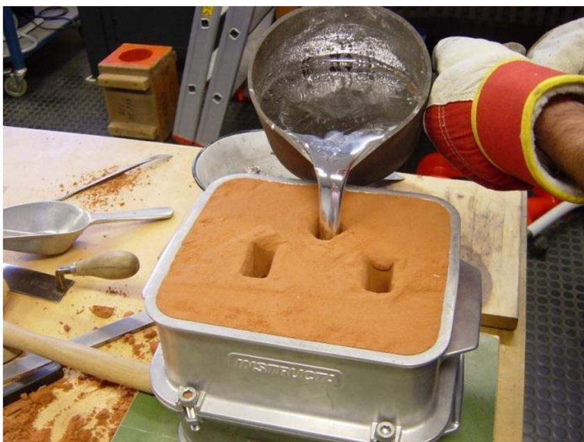
Рис. 3. Заливка литейной формы.
