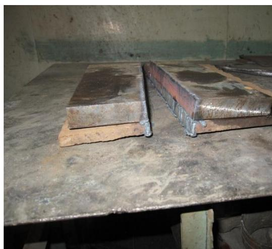
*Резка стали толщиной 40 мм*
