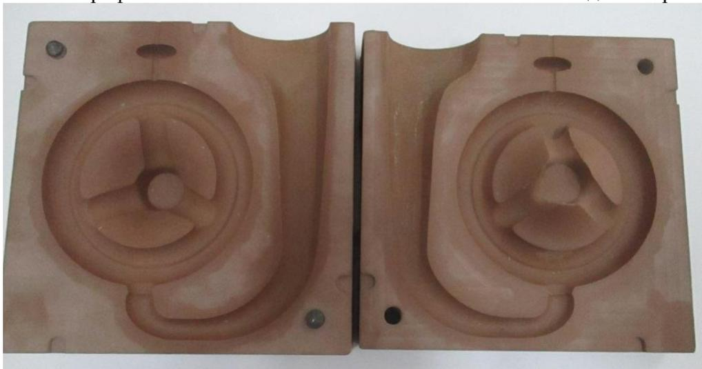
Рис.9. Модельная оснастка для изготовления литейной восковой модели.
