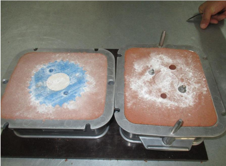
Рис. 12. Формовка детали “Звездочка”.
