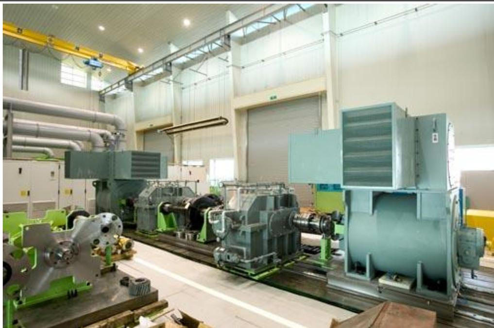
Рис. 7. Испытательная станция элементов привода
