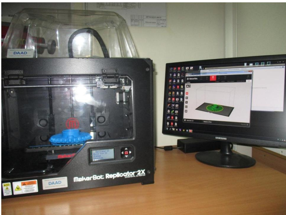
*Рис. 11. Распечатка модели детали “Звездочка” на 3D принтере.*
