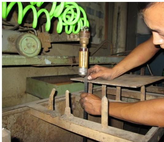
*Настройка расстояние плазмотрон-металл*
