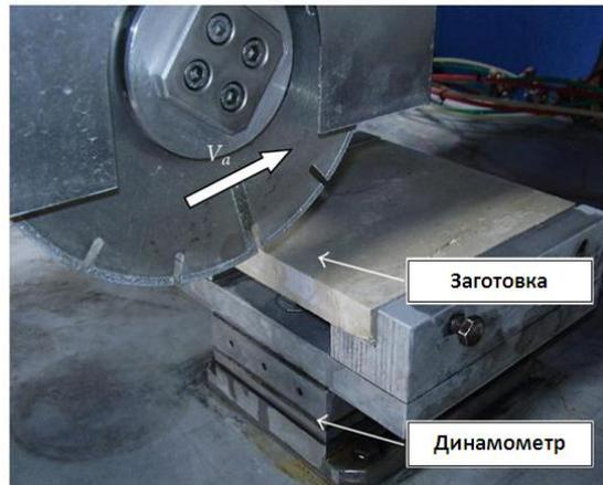
Рис.5. Динамометр для измерения сил резания  $P_z$ ,  $P_y$ ,  $P_x$ .
