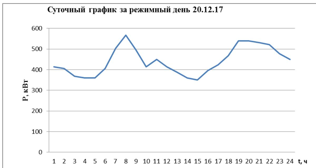
Рис. 2. Суточный график за режимный день 20.12.2017 фидера «Телочник»
