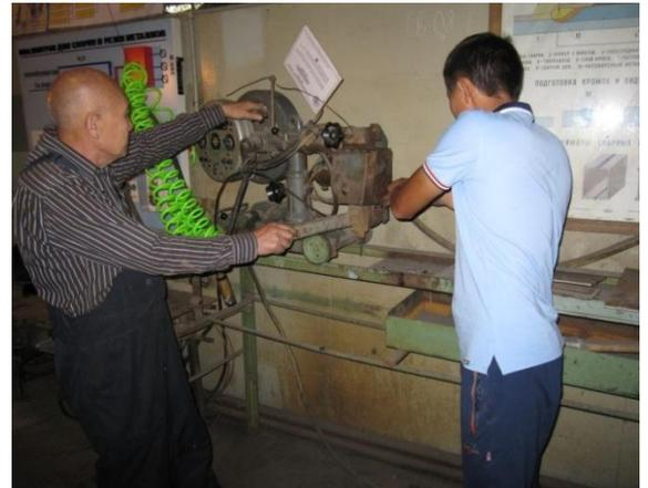
*Ремонт систему перемещения и подъема плазмотрона*
