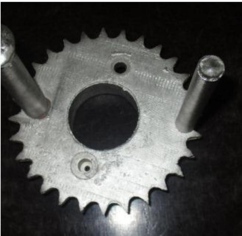
Рис.13. Отливка детали “Звездочка”.
