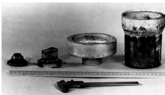
Рисунок 1- Детали «стакан» (АМг5), «корпус» (В48), «крышка» (АК4), «сферическая опора» (Д18Т)
