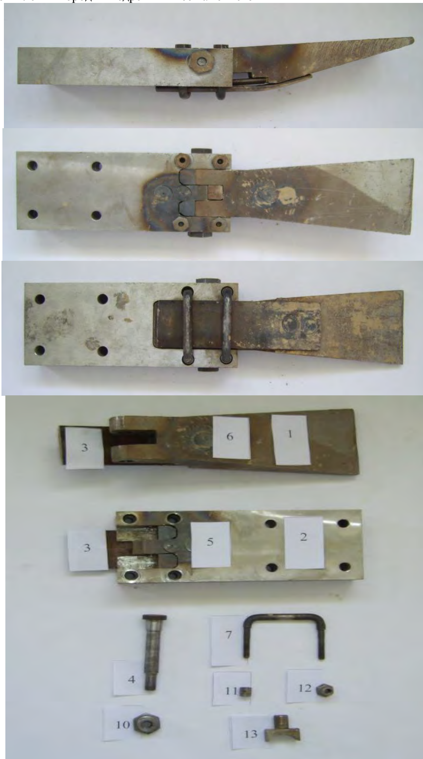
Рис.2. Зуб ковша с упругими элементами: 1 – зуб, 2 – оправа, 3 – упругие элементы, 4 – ось, 5 – крепление упругого элемента к оправе, 6 – крепление упругого элемента к зубу, 7 – скоба, 10 – гайка, 11 – втулка, 12 – гайка, 13 – сухарик
