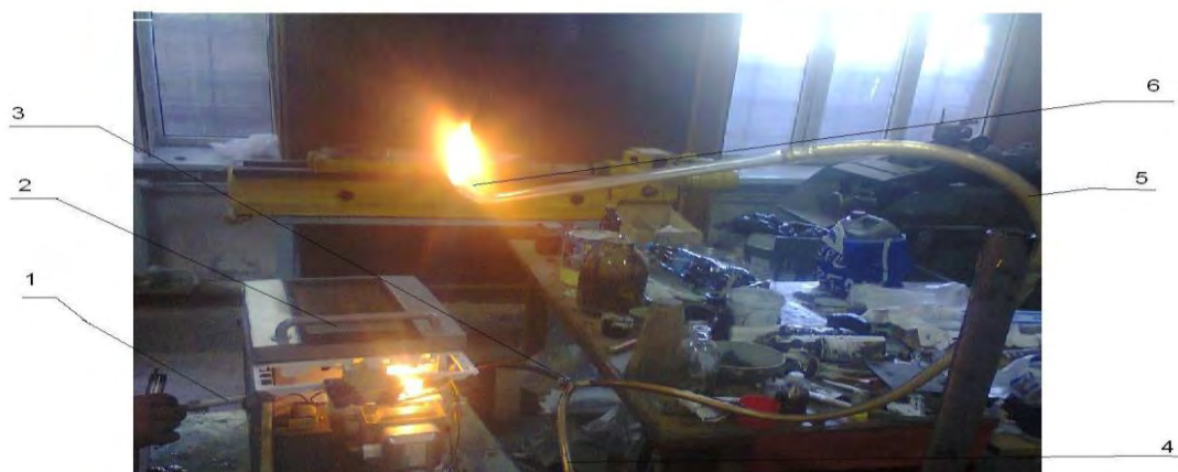
Рис. 2. Фотография эксперимента пиролиза мазута в плазменной среде
