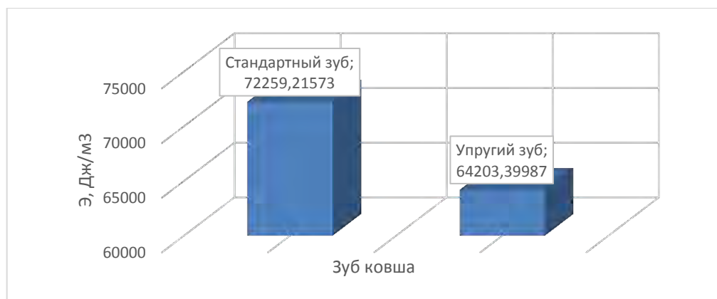
Рис. 7. Гистограмма энергоёмкости процесса разрушения породы, содержащей каменистое включение стандартным и упругим зубом ковша
