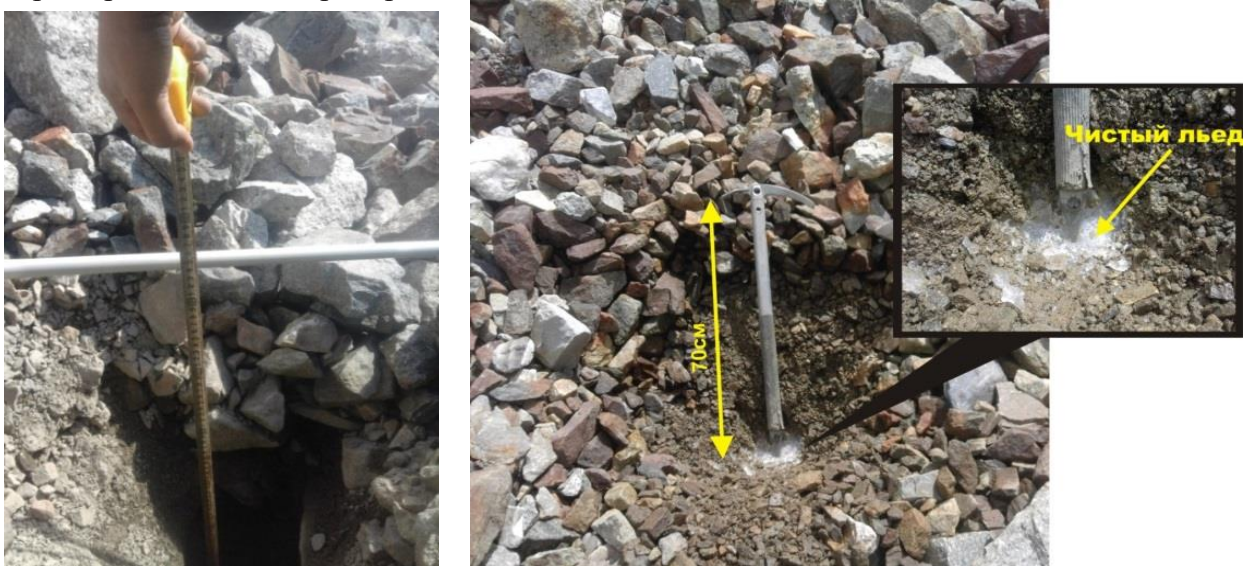
Рис. 3. Измерение толщины мореного чехла на забронированном участке ледника и искусственное обнажение льда. В точке измерения толщина мореного чехла составила 70 см.
