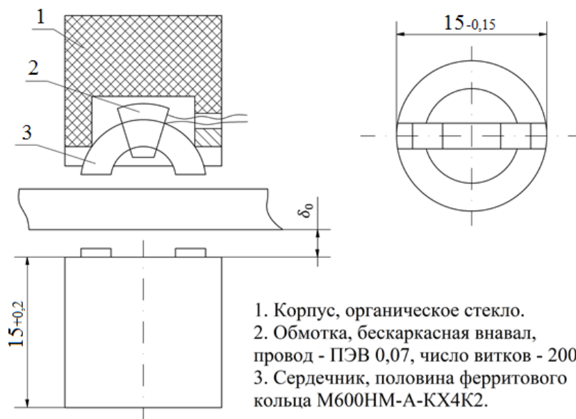
Рис. 6. Обмотка преобразователя
