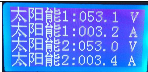
Рис.5. Показания двухканального инвертора «INV-A1-5kW+48V/300A производства КНР: среднее входящее постоянное напряжение и сила тока контроллеров заряда
