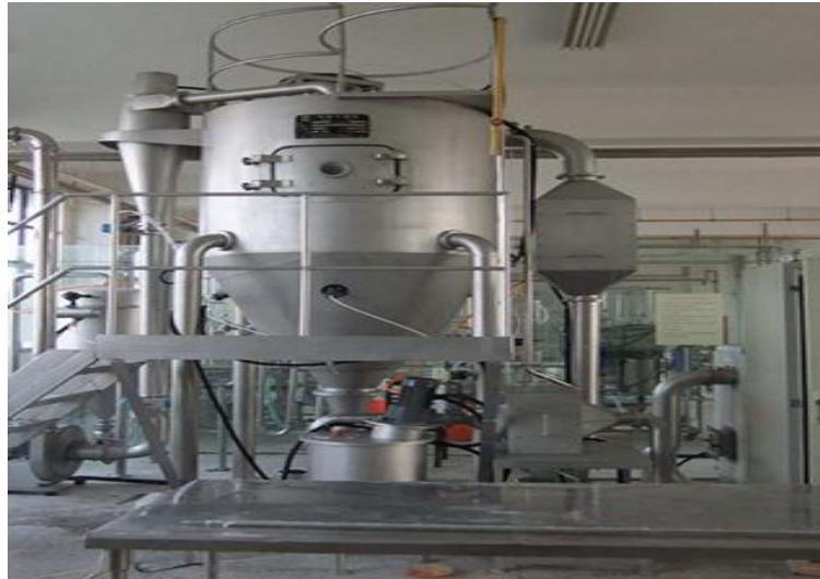
Рис.1. Распылительная дисковая сушилка Q = 1000 кг/ч
