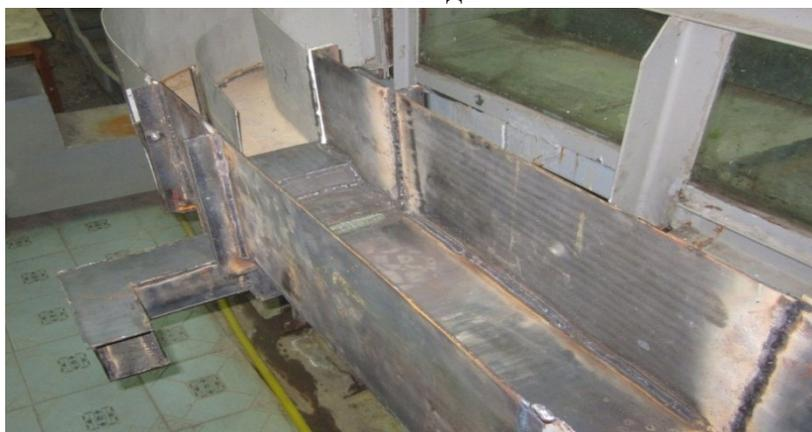
Рис. 3. Лабораторная модель водовыпуска-стабилизатора расхода воды из каналов с бурным режимом течения
