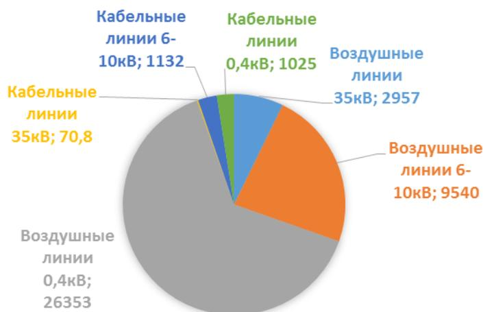
Рис. 1. Распределение протяженности распределительных сетей РЭК Кыргызстана.
