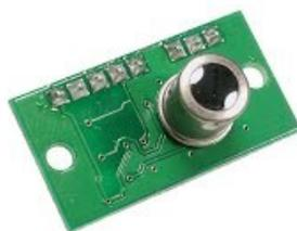
Рис. 2 датчик тепловизора который будет подсоединен к плате ардуино
