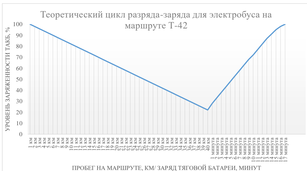
Рис.5. Теоретический режим эксплуатации (разряд-заряд) ТАКБ электробуса КАМАЗ 6282-12
