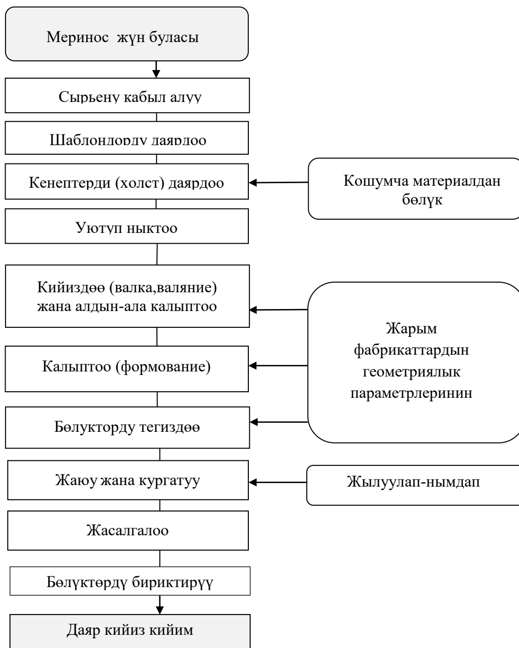
1 – сүрөт. Кийиз кийимдерин тигишсиз даярдоо процессинин структурасы
