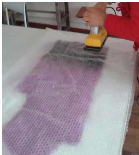
4-сүрөт. DFS-135N маркасындагы титирек-бүлөөчү машинка менен кенепти уютуп ныктоо
