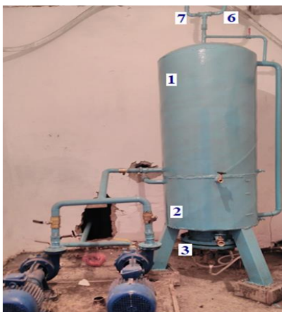
Рис. 6. Опытный образец водогрейный котла с компактной паровой камерой и теплообменником оригинальной конструкции: 1-корпус паровой камеры, 2-корпус для парообразующей жидкости, 3-нагревательный элемент, (4-теплообменник, 5- кольца-соты внутри корпуса), 6-манометр, 7-предохранительный клапан.
