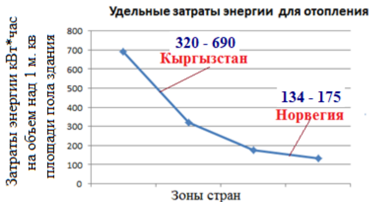
Рис. 1. Сравнительный график энергоэффективности отопления зданий в Норвегии и Кыргызстане.
