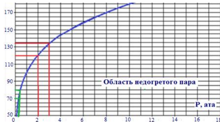
Рис.3. Классическая диаграмма линии насыщения системы «вода-пар».
