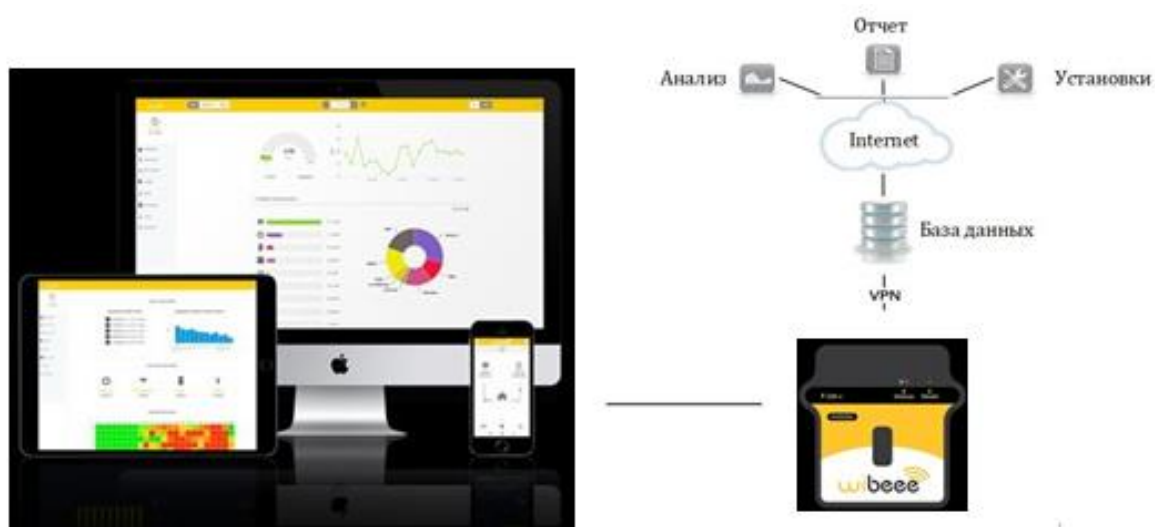
Рисунок 3. Работа Kazenergy 16 с онлайн счетчиком Wibe для отражения всех электротехнических параметров в реальном времени
