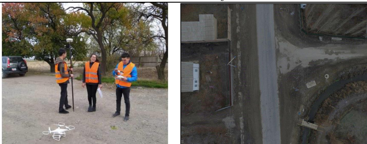
Рис. 1. а) Подготовка БПЛА DJI Phantom 4 к полету; б) Цифровая фотография местности, полученная с БПЛА
