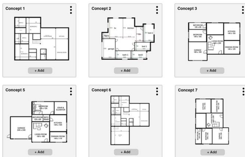
Рис. 4. Сгенерированные с помощью AI-Maket варианты планировок (Generative Design for Architectural Planning)
