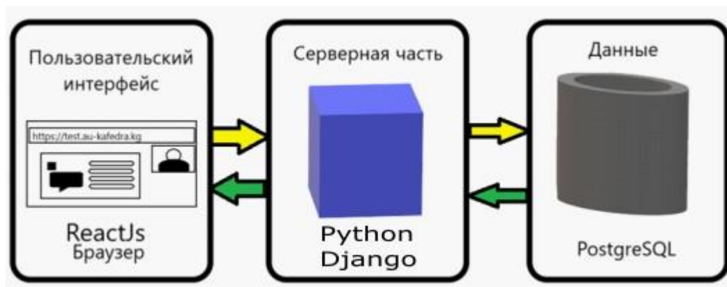
Рис. 2. Архитектура системы тестирования
