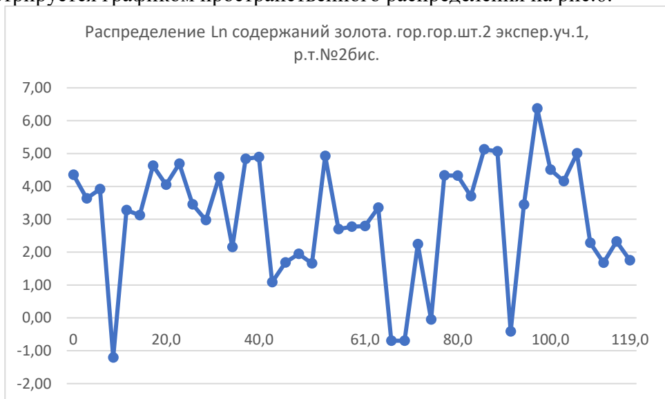
Рис.6. Изменчивость золота (Ln) по простиранию рудного тела №2бис, гор. шт.2 (119 м, шаг опробования 2,8м).
