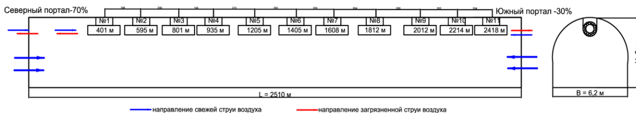
Рис.2. Схема расположения вентиляторов при продольной схеме вентиляции тоннеля
