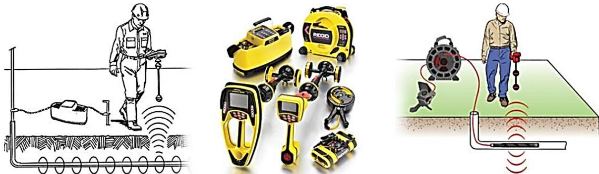
Рис. 6. Определение местоположения подземных коммуникаций и глубины их заложения специальными приборами – трассоискателями и трубокабелеискателями
