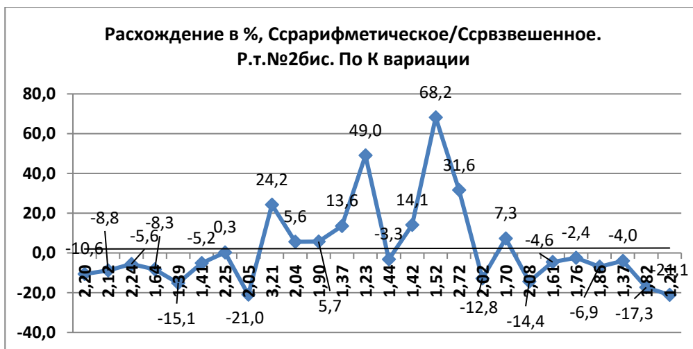
Рис.8. Погрешности исчислений средних содержаний по разведочным блокам и исчисленной вариацией содержаний золота, р.т.№2бис.
