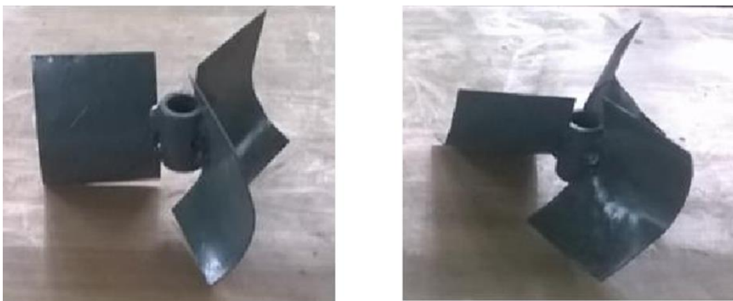
Рис 2. Конструкции лопастей испытанных турбин
