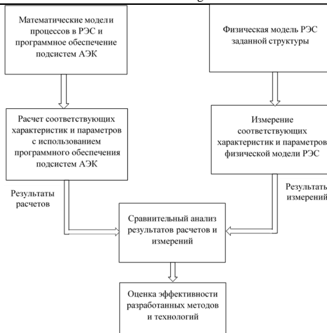
Рис. 4. Обобщённая схема экспериментальных исследований на базе АЭК
