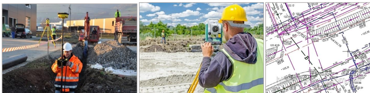
Рис. 5. Съёмка инженерных коммуникаций спутниковыми приемниками и электронными тахеометрами, составление плана инженерных коммуникаций в программе AutoCAD
