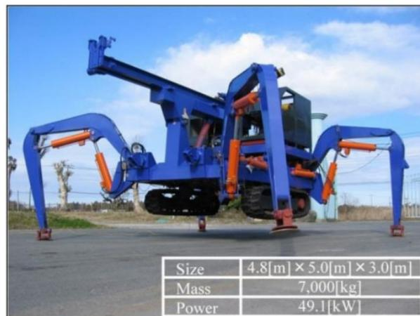
Рис. 9. Колёсно-шагающая машина Titan 11 (Япония)
