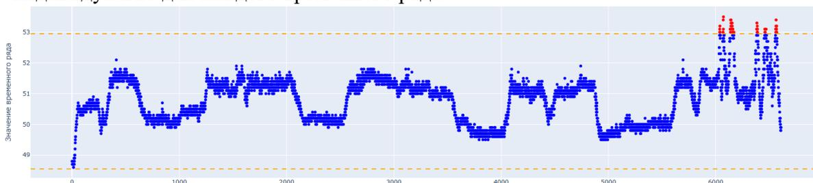
Рисунок 1 – Обнаружение аномалий методом межквартильного размаха
