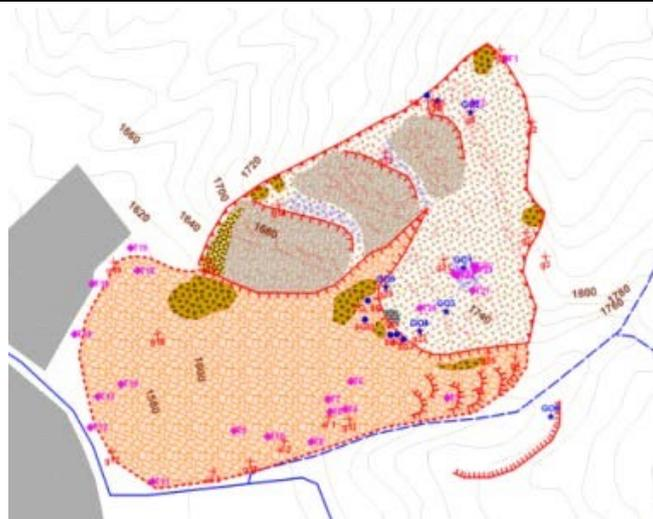
Рисунок 5 - Компьютерная GIS карта-схема оползне-опасных склонов на примере оползня «Гульча» (Ошская область)
