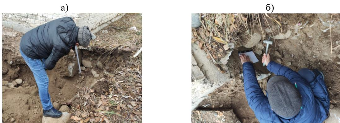
Рисунок 16 - Общий вид работ по определению марки (прочности) бетона фундамента здания
