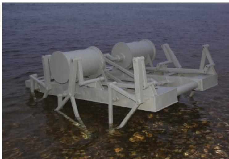
Рис. 10. Подводный шагающий аппарат МАК-1
