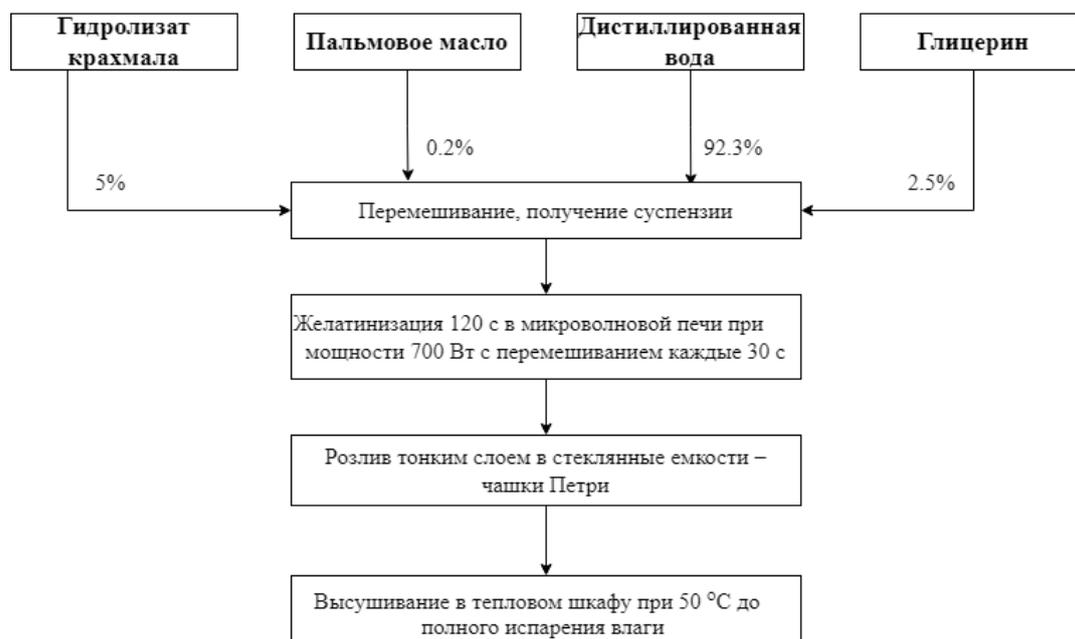
Рисунок 8 - Методика получения нанопленок из гидролизата крахмала
