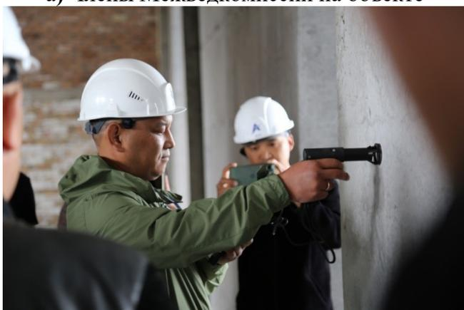
в) Проверка прочности бетона конструкций
