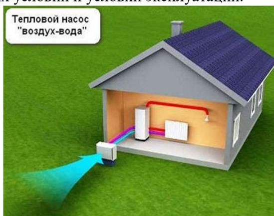
Рисунок 2 - Тепловой насос «Воздух-вода» [3]
