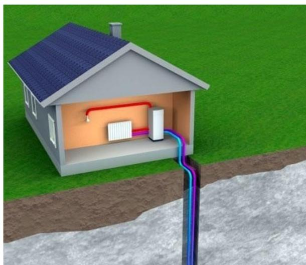
Рисунок 4 - Тепловой насос «Грунт-Вода» [4]
