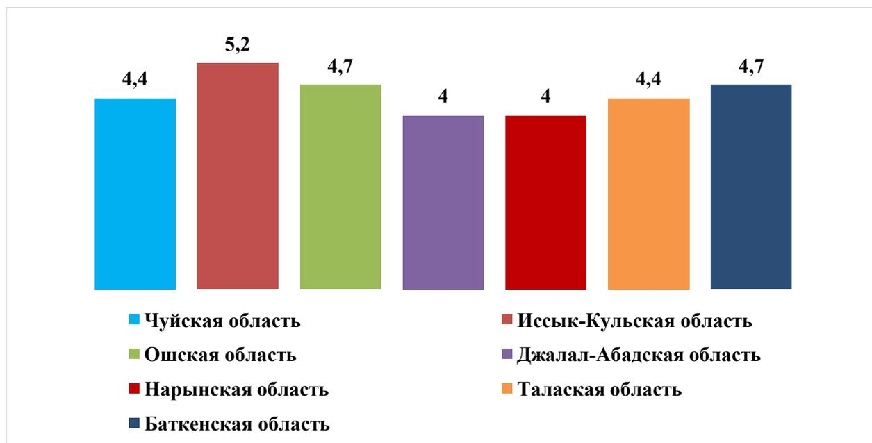
Рисунок 6 - Показатели коэффициента COP для различных регионов Кыргызстана при низкотемпературной системе отопления 55/40°C
