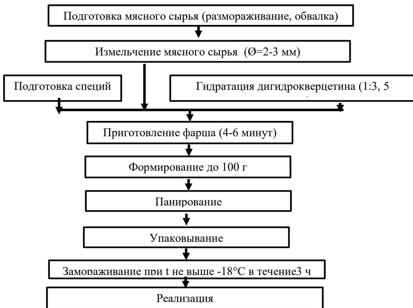
Схема 1 – Технологическая схема производства мясных рубленых полуфабрикатов
