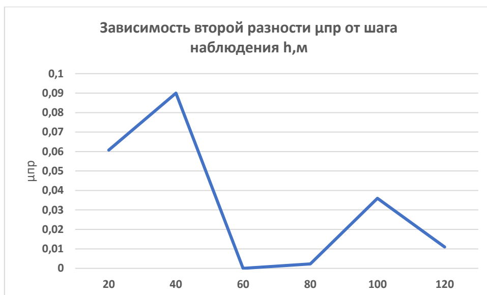
Рисунок 11 - Зависимость второй разности \mu_{пр} от шага наблюдений h, м
