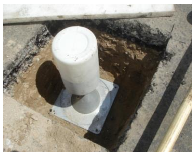
Рисунок 4 – Лунки для отсыпки песка при определении плотности слоев дорожной одежды
