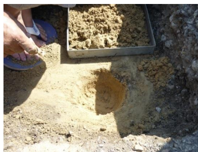
Рисунок 5 – Отбор проб материала в поддон
