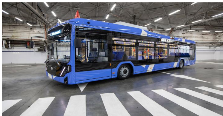
Рисунок 1 - Одна из ведущих моделей троллейбусов с автономным ходом "Ольгерд"
