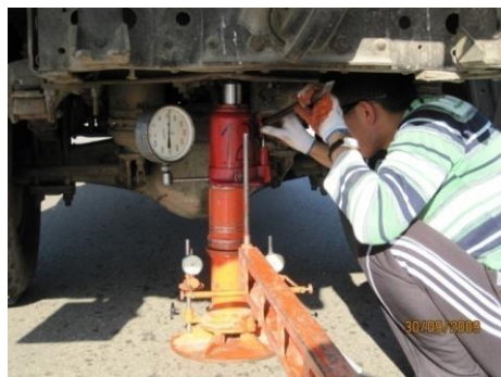
Рисунок 9 – Штамповое испытание прочности дорожной одежды
