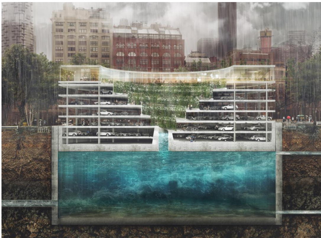
Рисунок 4 – Разрез парковки при заполненном резервуаре водохранилища
