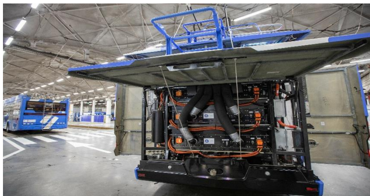
Рисунок 2 - Блоки литий-ионных батарей троллейбусов с автономным ходом "Ольгерд"
