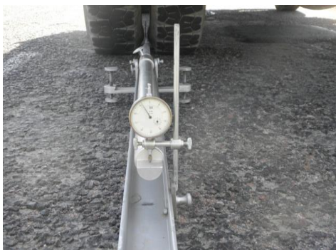
Рисунок 8 – Снятие показаний прогиба прогибомером МАДИ-ЦНИЛ
