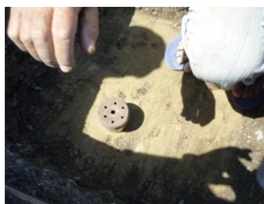
Рисунок 2 – Прибор для определения фактической плотности грунта земляного полотна
