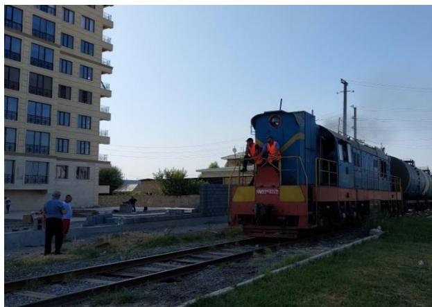
Фото 5 - Проведение динамического испытания подвижным составом
