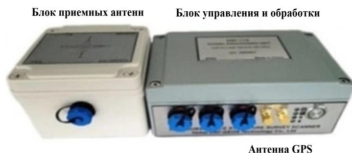
Рисунок 2 – Приемник DSF для установки на беспилотные летательные аппараты
