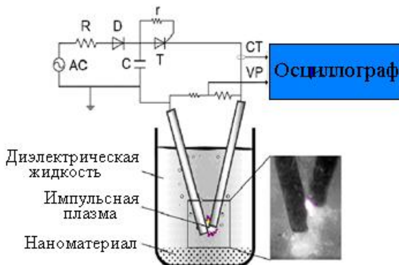
Рисунок 1 - Технологическая схема для диспергирования металлов в ИПЖ
