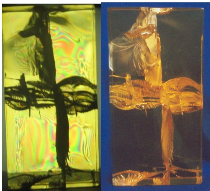
Рисунок 3 - Образец №3 после нагружения и самопроизвольного развития внутренних единичных поперечных, продольных трещин в средней части, не выходящих на границы и поверхности (самопроизвольное развитие трещин с 27. 07. 2002 г по 14.03.2011 г. и по настоящее время 2024 г. с выходом на границы и поверхности образца при отсутствии внешней нагрузки)
